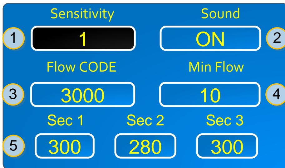
1. **СКОРОСТЬ РЕАКЦИИ АВТОМАТИКИ.** Значения меняются от 1 до 10. Чувствительность подбирается после монтажа системы и обеспечивает устойчивую работу с учетом реализованной конструкции.
